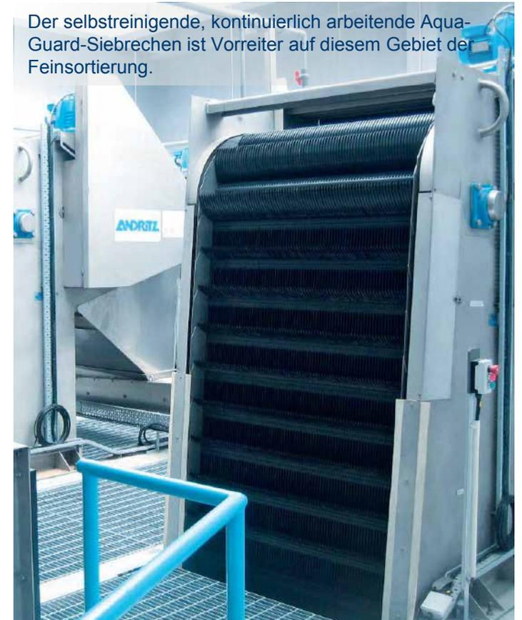
Der selbstreinigende, kontinuierlich arbeitende Aqua-Guard-Siebrechen ist Vorreiter auf diesem Gebiet der Feinsortierung.
